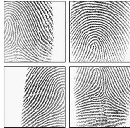
Quattro immagini diverse dello stesso dito acquisite con un sensore ottico di dimensioni 0.51" × 0.51"
